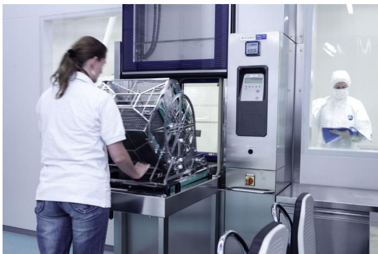
Die Nadeln für die ZipFix-Verbindungselemente werden über eine Reinstwasserreinigungsanlage in den Reinraum eingeschleust. (Bild: Samaplast)
