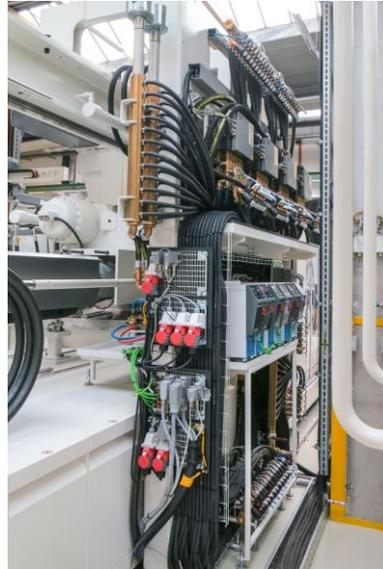
Kompakt integriert: Die Fertigungszellen sind mit e-flomos und Temperiergeräten ausgerüstet, die seitlich und hinter der Maschine Platz finden.
