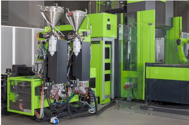
Die ENGEL Lösung für die In-situ-Polymerisation zur Produktion von faserverstärkten thermoplastischen Kunststoffbauteilen zeichnet sich durch eine besonders kompakte Anlagentechnik aus.
